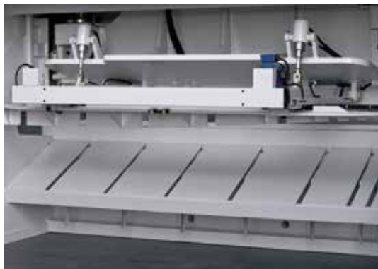
Sostegno pneumatico della lamiera in fase di scarico. Pneumatic sheet support during unloading phase.
