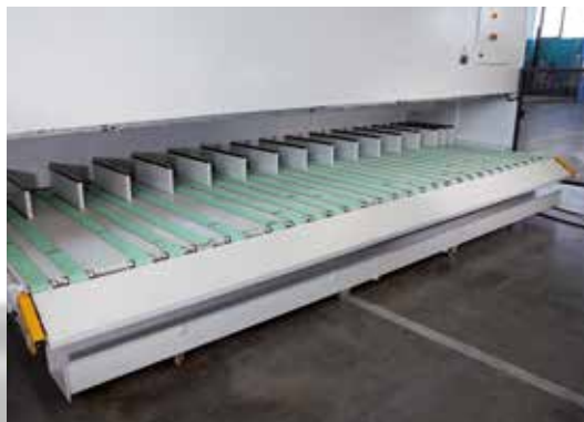
Convogliatore evacuatore con selettori sfridi. Belt conveyor with trim cut selector.
