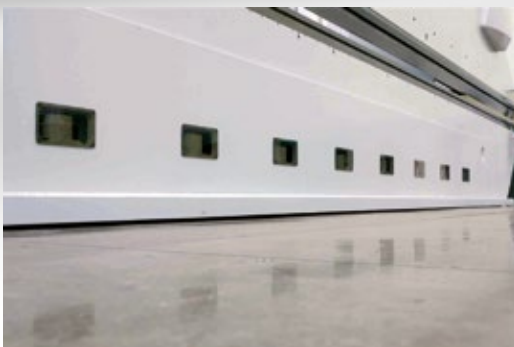
Centinatura idraulica parametrica gestita dal CNC. Parametric hydraulic crowning system controlled by CNC.
