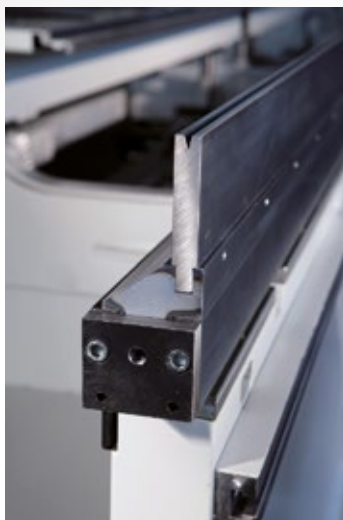
Piega-schiaccia pneumatico integrato modello PN 15 (contropiega 15 mm - opzionale).
