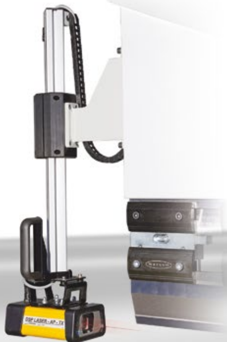
Sistema di sicurezza LAZER BEAM € € LAZER BEAM € € safety system device
