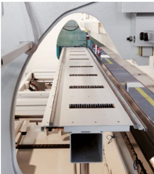
Particolare grande incavo da 750 mm. Particular of large gap of 750 mm.
