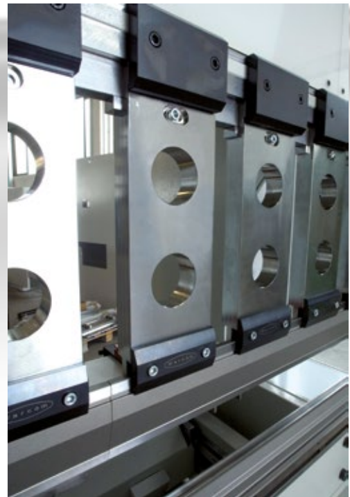
Intermedi con altezze maggiorate per esecuzione di profili scatolati in versione manuale o automatica.
