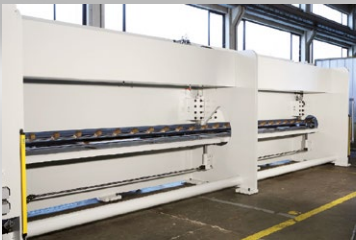
Tavola posteriore asse R gestita da CNC.
