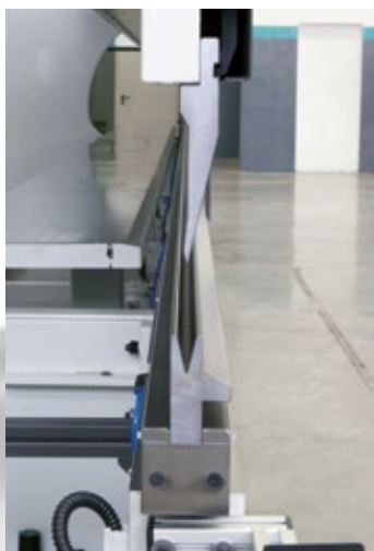
Matrice piega-schiaccia pneumatico modello PN 30 (contropiega 30 mm).
