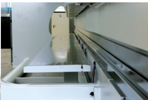
Supporto posteriore motorizzato corsa asse R 200 mm.
