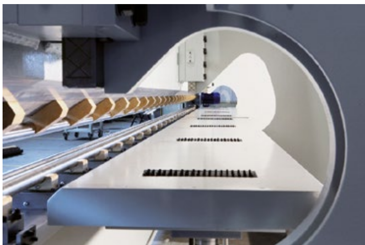
Particolare grande incavo da 750 mm a 1000 mm.
