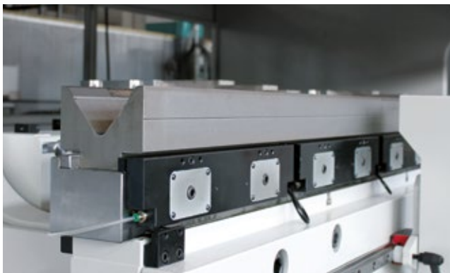
Bloccaggio pneumatico per matrici. Pneumatic die clamping.
