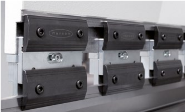
Intermedio standard con bloccaggio manuale. Standard intermediate with manual clamping.
